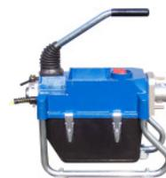
Schnappverschluss für Spiralschutz-Schlauch und Motorhauben-Befestigung. Klemmbacken-System ist aussenliegend an der Maschinen-Vorderseite angebracht. Robuster und kräftiger Spiralenklemmhebel. **Schalter oben**, links-0-rechts.
